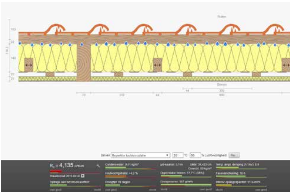
Voorbeeld constructieopbouw uit ubakus inclusief berekening condensatie
